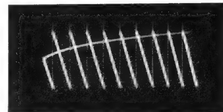
Bild 2. Spannungsverlauf an der Anode
