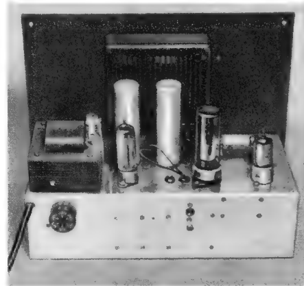
Bild 11. Rückansicht des fertigen Chassis mit Röhren, Netztransformator, Elektrolytkondensator und Meßinstrument
